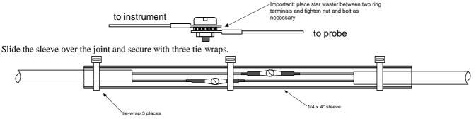
**INSTALLING THE EGT-701 SCANNER®**
