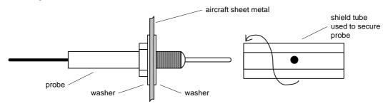
**INSTALLING THE EGT-701 SCANNER®**
