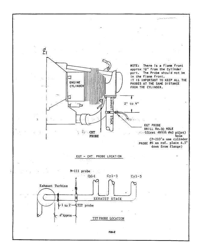
**INSTALLING THE EGT-701 SCANNER®**
